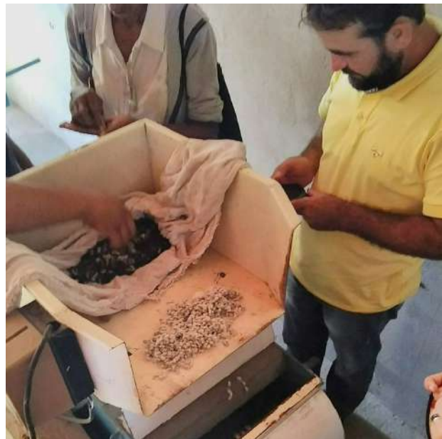
Sementes de algodão depois de passarem pela máquina para retirada da pluma
